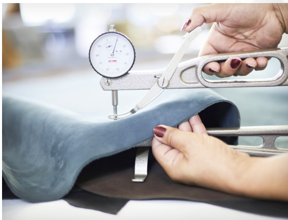
Messung der Lederdicke in den Lemaitre-Werkstätten
