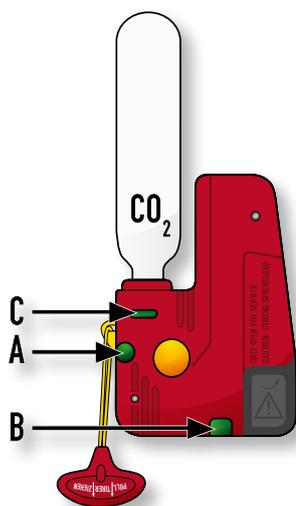
**Drei grüne Indikatoren zeigen A: Handauslösehebel gesichert B: Automatiktablette vorhanden C: CO2 Patrone korrekt eingeschraubt.**
